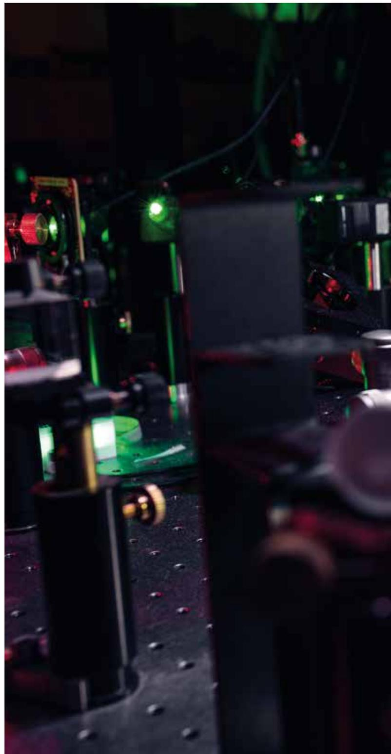
▲ **NUR SCHEINBAR CHAOTISCH:** Linsen und Spiegel lenken Laser um, mit denen Quantenzustände manipuliert werden können
